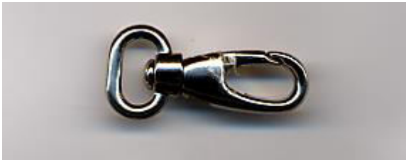
3608 Taschenkarabiner Öse 18 mm, Länge 38 mm vermessingt, vernickelt
